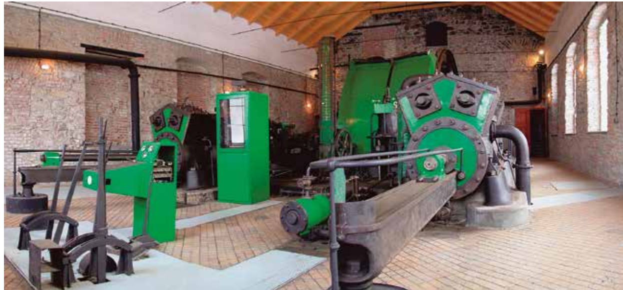
Příbram, Příbram Mining Museum (Hornické muzeum Příbram), Vojtěch mine, steam winding engine from 1889. Photograph Příbram Mining Museum, 2015.
